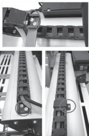
Fig. 7 – Esteira porta cabos
